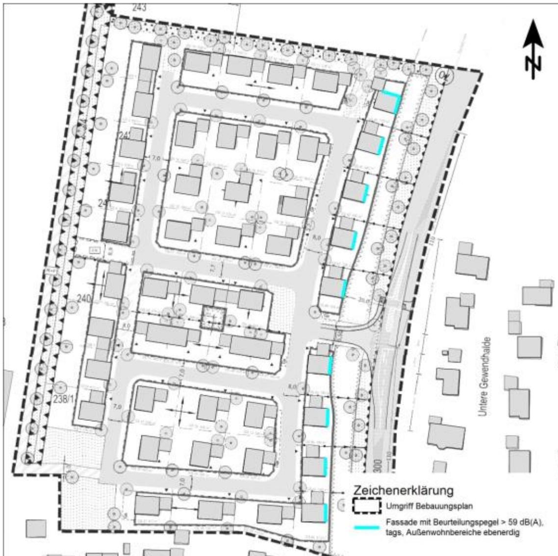
Außenwohnbereiche in den Obergeschossen wie Balkone sind an den Fassaden mit Beurteilungspegel, tags (6:00 Uhr bis 22:00 Uhr) von mehr als 59 dB(A) unzulässig. Die davon betroffenen Fassaden sind dem nachfolgenden Lageplanausschnitt zu entnehmen.
